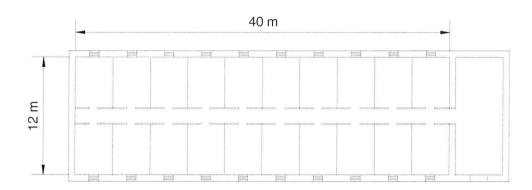
Ogni ufficio sarà dotato di ventilconvettore di potenza 2,5 kW la cui batteria ha una perdita di carico pari a 12 kPa.
